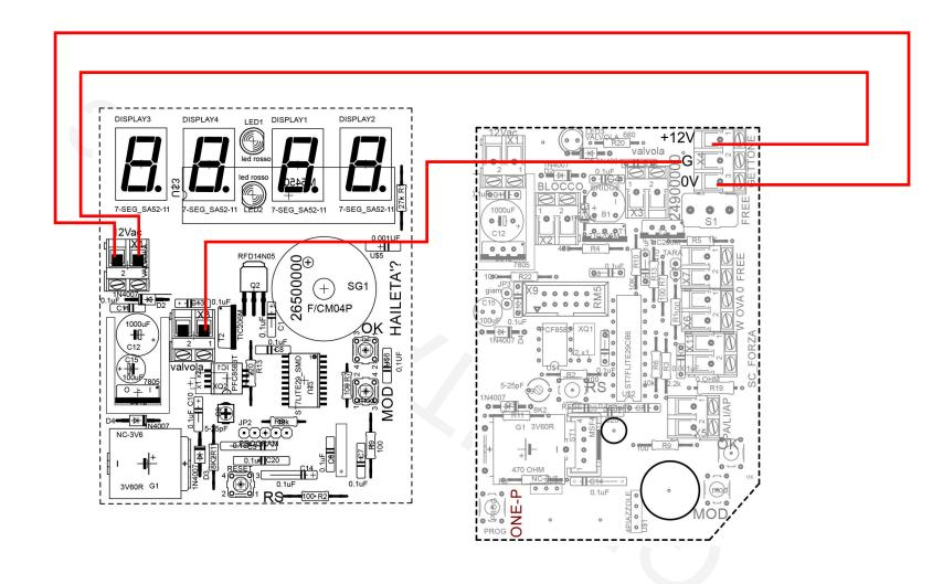
nota: Da HAILETA eliminare led, diodo led e resistenza del led di uscita. sostituire TRIAC con MOS ed adeguare la resistenza di polarizzazione del MOS
